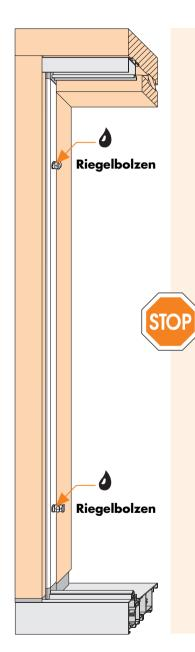
Ihr Hebe-Schiebe-Element ist mit einem hochwertigen SIEGENIA-AUBI-Beschlag ausgestattet. Damit seine Leichtgängigkeit und einwandfreie Funktion erhalten bleibt, müssen Sie folgende Wartungsarbeiten mindestens einmal jährlich durchführen (lassen):
